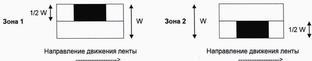
Рисунок 1 — Расположение испытательных нагрузок при оценке погрешности в режиме динамического взвешивания объектов измерений при их нецентрированном положении при движении по конвейерной ленте
