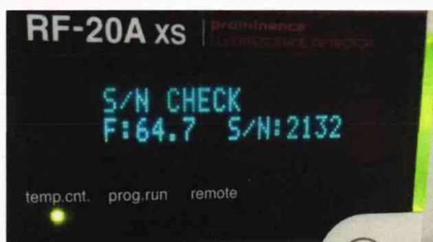
Рисунок 24 – Пример результата определения отношения сигнал-шум (S/N)
