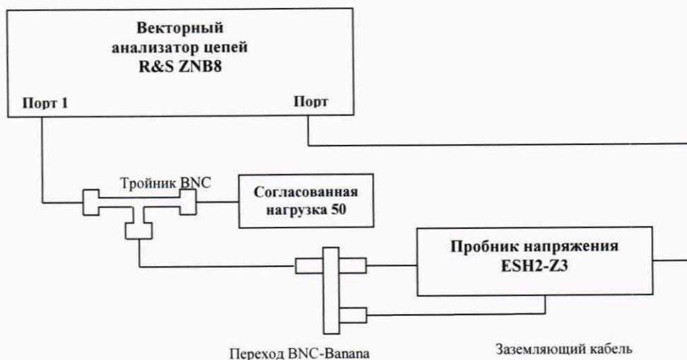
Рисунок 1 – Схема соединения приборов для определения абсолютной погрешности коэффициента передачи.
