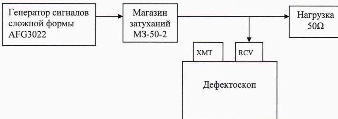
Рисунок 2 - Схема соединений для определения абсолютной погрешности установки усиления приемника дефектоскопа
