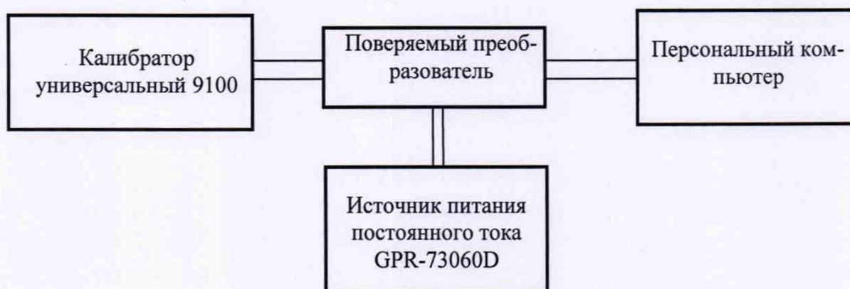
Рисунок 1 – Схема структурная определения погрешностей измерений преобразователей
