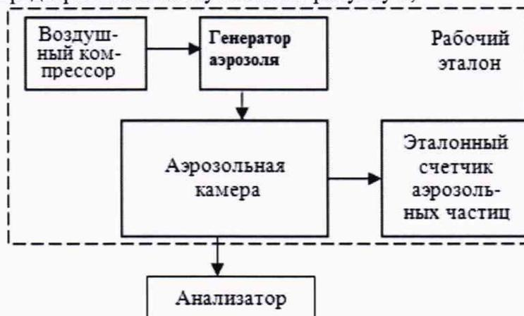
Рисунок 1- Схема поверки
