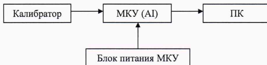
Рисунок 1 – Схема подключения ИК при измерении силы постоянного тока
