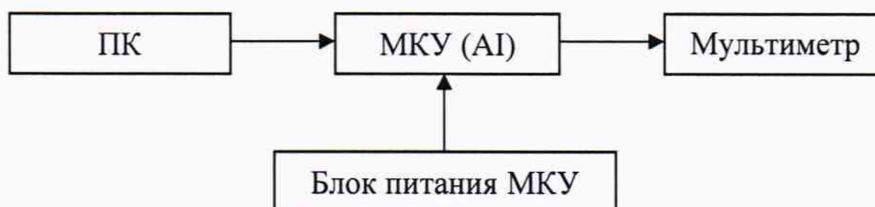
Рисунок 2 – Схема подключения ИК при воспроизведении силы постоянного тока
