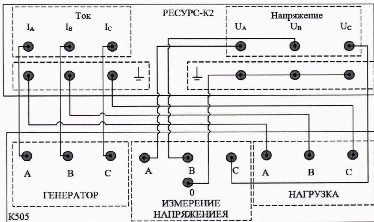
Рисунок 1 - Схема определения относительной погрешности измерения активной мощности
