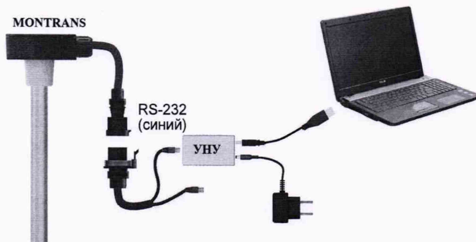
Рисунок А.1 – Схема подключения датчиков уровня топлива MONTRANS к ПК по интерфейсу RS-232
