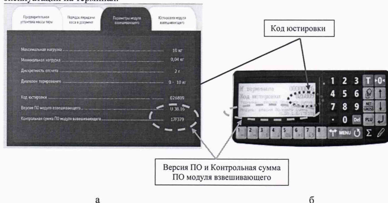
Рисунок 1 – Индикация кода юстировки, версии ПО и контрольной суммы ПО модуля взвешивающего: а – на мониторе компьютера, б – на терминале.
