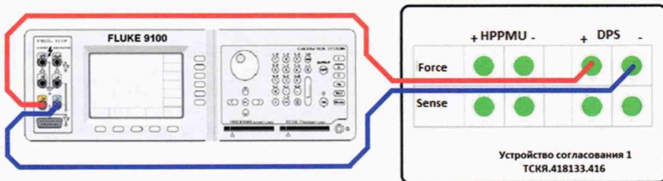
Рисунок 26 –Схема определения абсолютной погрешности измерения силы тока источником питания MS DPS на пределах 0,3; 4; 8 А
