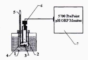
1 — жидкостной термостат, 2 — сосуд с буферным раствором ОВП, 3 — якорь магнитной мешалки, 4 — комбинированный электрод ОВП с термодатчиком, 5 — термометр, 6 — предусилитель с кабелем, 7 — измерительный преобразователь.
