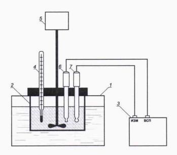
1 — жидкостной термостат; 2 — стакан с анализируемой жидкостью; 3 — измерительный преобразователь»; 4 — термометр ртутный; 5 — мешалка пропеллерная; 6 — вспомогательный электрод (электрод сравнения) из комплекта анализатора; 7 — измерительный электрод
