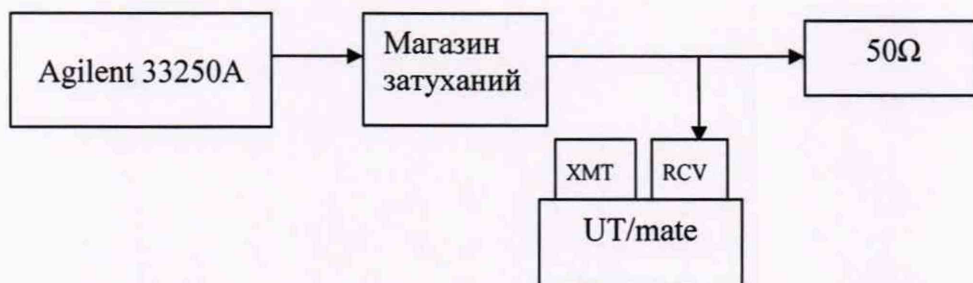
Рисунок 3 - Схема соединений при проверке параметров установки усиления и полосы пропускания фильтров приемника
