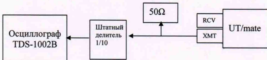
Рисунок 1 - Схема соединений при определении амплитуды и длительности импульсов возбуждения
