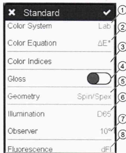
Рисунок 8 - 1 - Color System (Система цвета); 2 - Color Equation (Уравнение расчета отличий); 3 - Color Indices (Цветовые индексы); 4 - Gloss (блеск): включение/отключение; 5 - Геометрия: выбор Spin/Spex; 6 – Осветитель; 7 – Наблюдатель; 8 – Индекс флуоресценции
