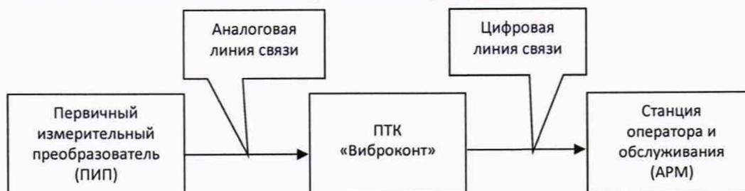
Рисунок 1 - Типовая блок - схема ИК
