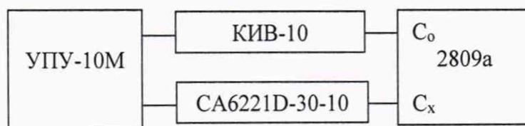
Рисунок 2 - Схема измерений тангенса угла потерь
