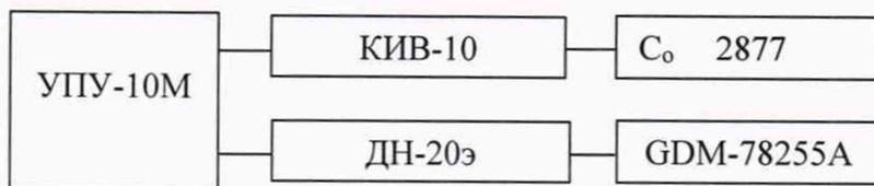
Рисунок 3 - Схема измерений напряжения и частоты переменного тока
