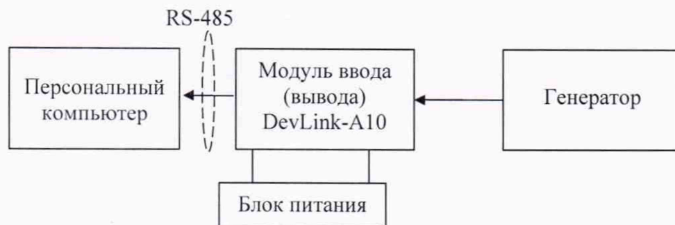
Рисунок А.4.2 – Схема соединений при проверке счёта импульсов (при наличии только модулей ввода (вывода) DevLink-A10)
