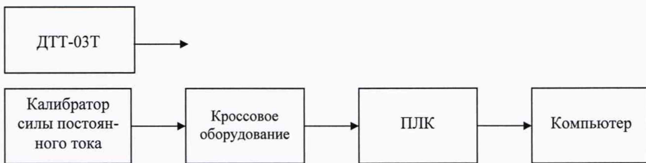
Рисунок А.5 - Схема определения приведенной к ВП погрешности измерений среднеквадратических значений силы переменного тока ВПУ испытуемых изделий
