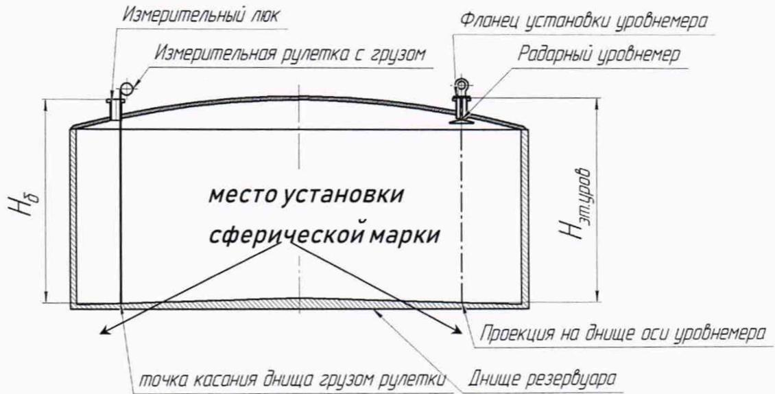
Рисунок А.1 – Схема измерения базовой высоты резервуара и эталонного расстояния уровнями
