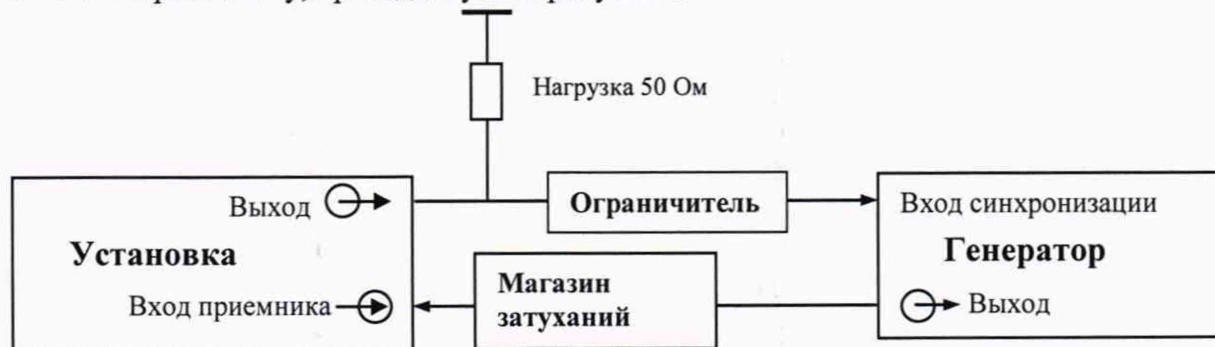
Рисунок 1 – Схема соединения для определения абсолютной погрешности измерений амплитуд сигналов на входе приемника
