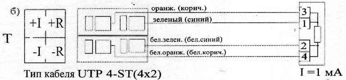
**3. Схема подключения первичного преобразователя расхода**
