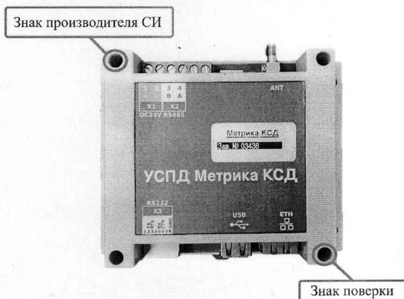
Рисунок В:2 – Схема пломбировки УСПД
