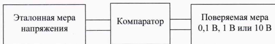
Рисунок 1 – Схема сличения поверяемой меры с эталонным СИ
