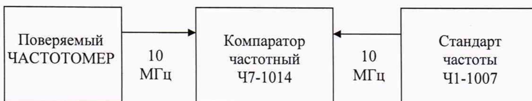
Рисунок 1 – Схема определения нестабильности и относительной погрешности по частоте опорного генератора частотомера
