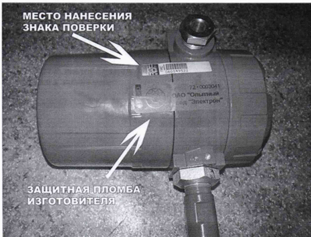
Рисунок В.1 – Схема нанесения знака поверки на корпус датчика
