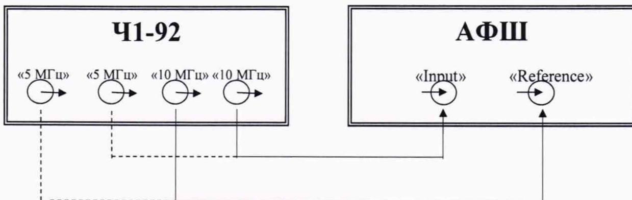
Рисунок 1 – Схема проверки функционирования АФШ
