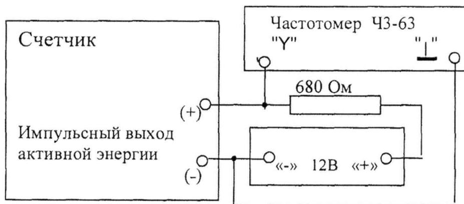
Рисунок А.1 - Схема проверки погрешности хода часов
