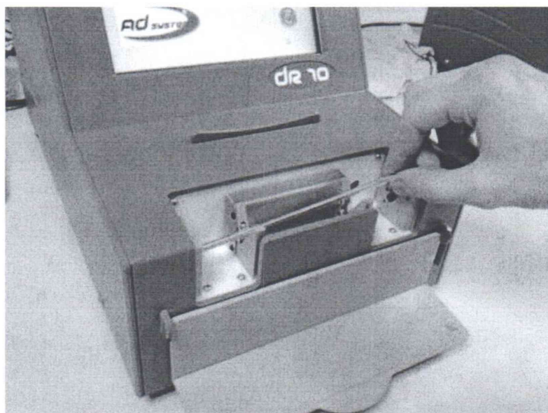
Рисунок 2 - Установка меры на опоры в тестовом отделении
