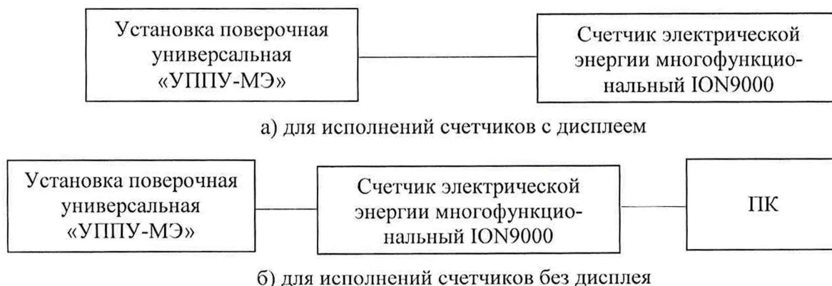
Рисунок 1 – Схемы подключений при определении метрологических характеристик счетчиков
