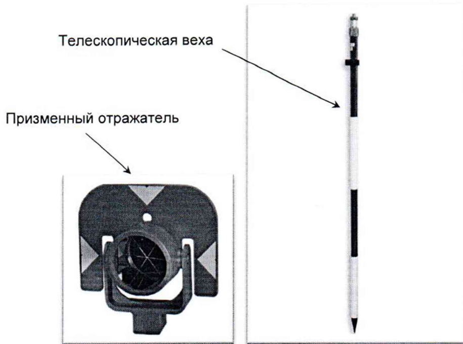
Рисунок А.1 – Веха телескопическая с призмным отражателем
