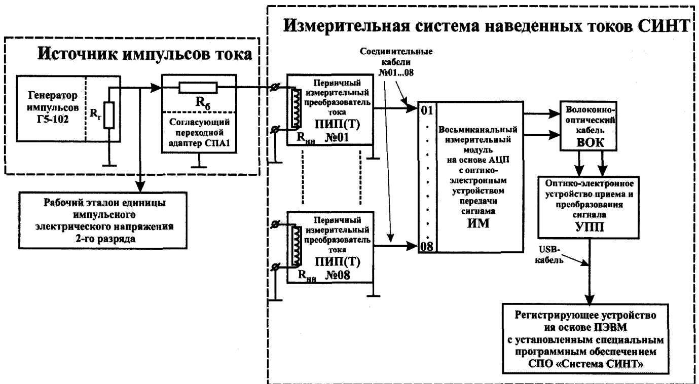
Рисунок 1 – Схема соединений при проведении измерений системы СИИТ
