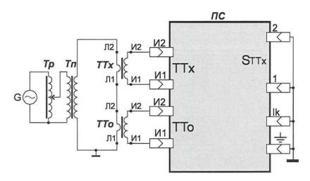
G~ -сеть; Тр - регулировочный трансформатор источника тока; Тп - источник тока;
