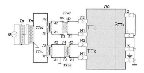
G~ -сеть; Тр - регулировочный трансформатор источника тока; Тп - источник тока;
