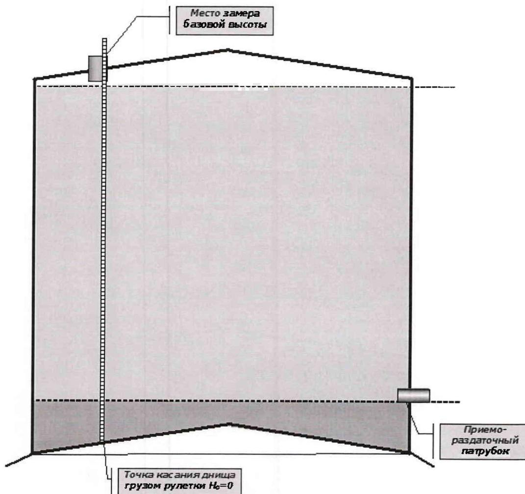
Рисунок А.1 — Схема измерения базовой высоты резервуара и эталонного расстояния уровнемера
