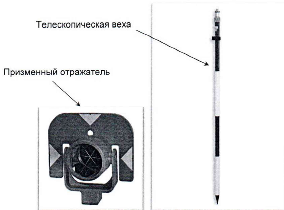
Рисунок А.1 – Веха телескопическая с призмным отражателем
