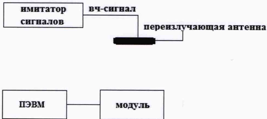
Рисунок 1 - Схема проведения измерений при опробовании, определении абсолютной инструментальной погрешности определения координат местоположения и скорости
