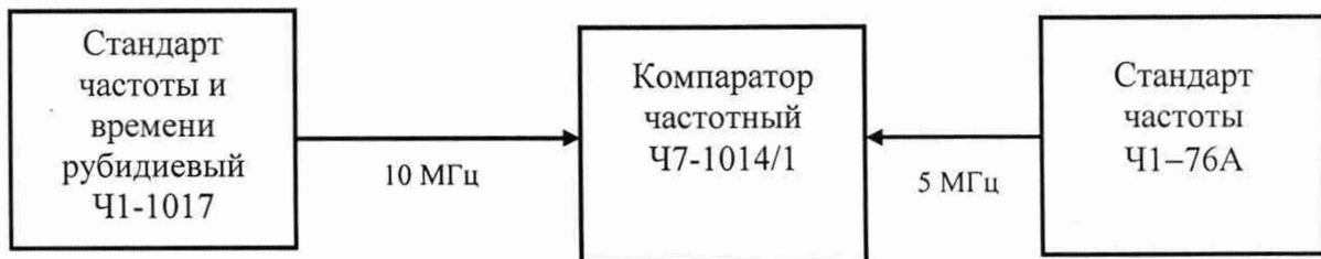
Рисунок 7.3 – Структурная схема подключения приборов для измерения среднего квадратического относительного двухвыборочного отклонения частоты сигнала 10 МГц за время измерения 1 с, 10 с, 100 с, 1 сут, относительной погрешности по частоте выходного сигнала 10 МГц и среднего систематического относительного изменение частоты выходного сигнала 10 МГц за 1 сут.
