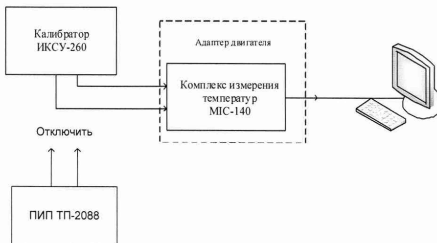
Рисунок 19 – Схема поверки электрических частей ИК температур газообразных сред с ПИП термоэлектрического типа ТХА (К), ТХК(L)
