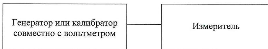
*Примечание: Генератор использовать для сигналов свыше 20 мВ; калибратор совместно с вольтметром использовать для сигналов до 20 мВ.*
