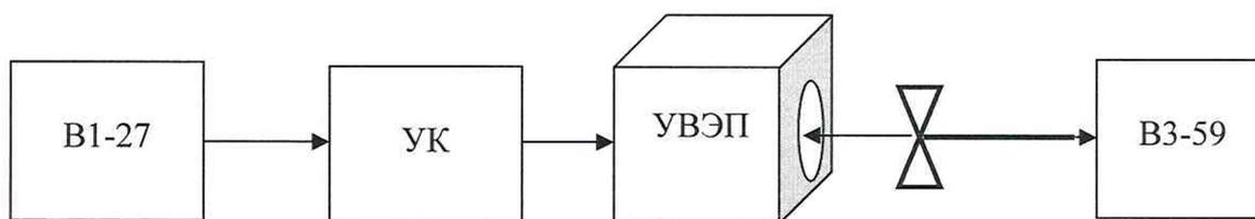
Рисунок 1 - Структурная схема измерений на УВЭП
