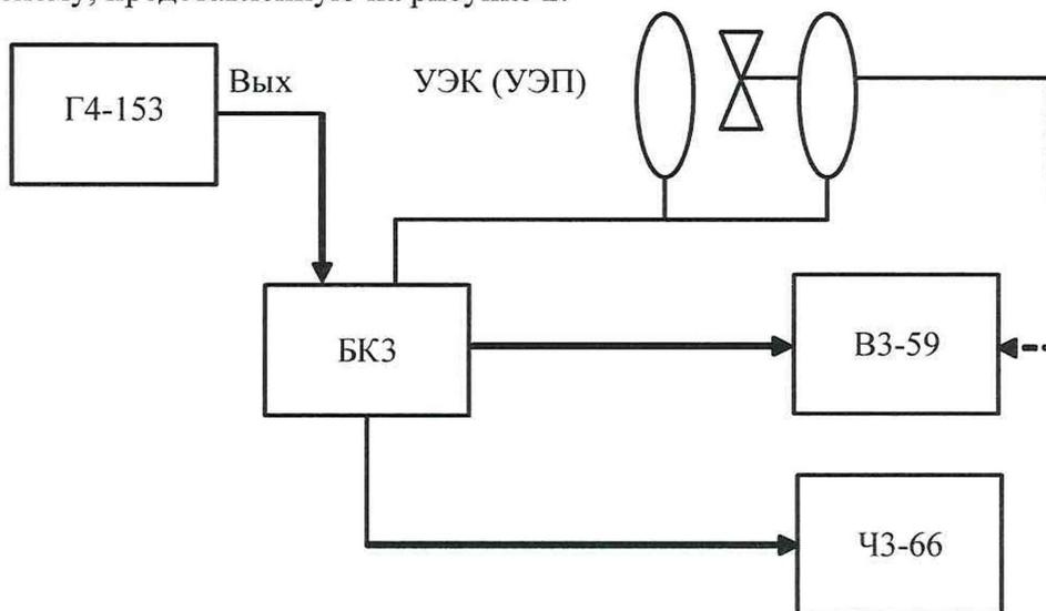
Рисунок 2 - Структурная схема измерений на УЭК, УЭП
