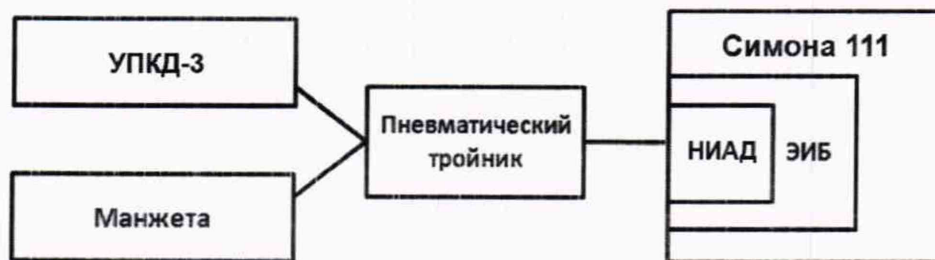
Рисунок 5 - Схема подключения приборов при определении метрологических характеристик канала НИАД.
