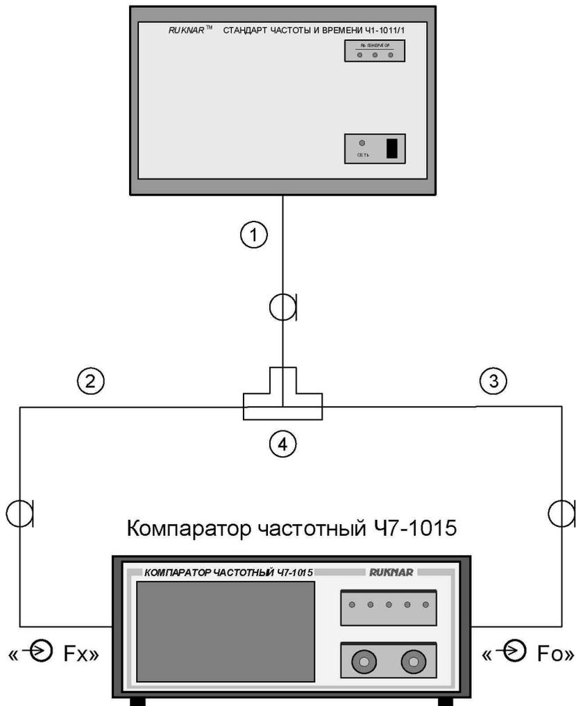
Рисунок 7.3 – Схема электрическая подключения приборов для определения среднеквадратического относительного отклонения результата измерений частоты.
