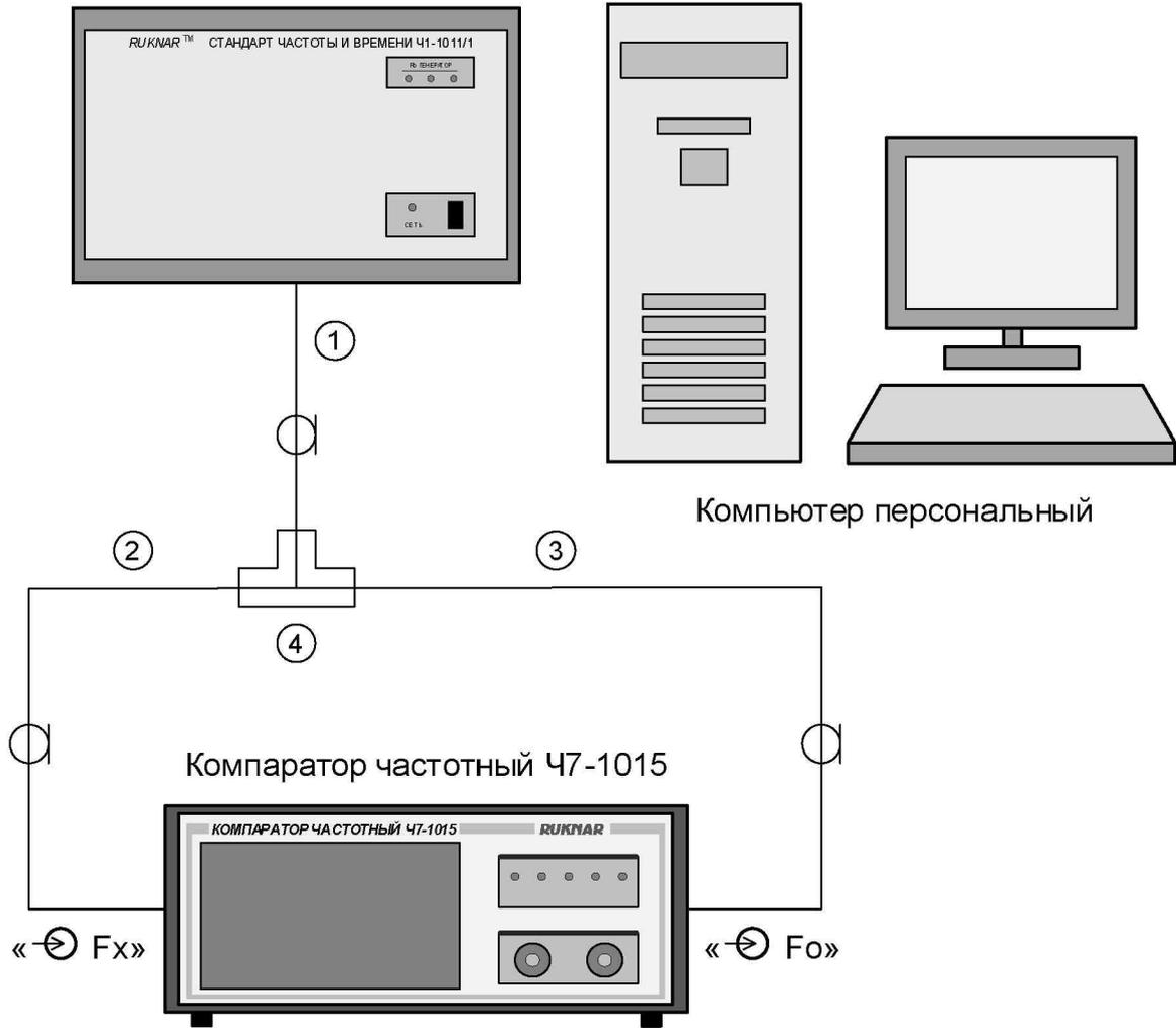
Рисунок 4 – Схема электрическая подключения приборов для проверки обработки информации, интерфейсных функций и прикладного программного обеспечения.
