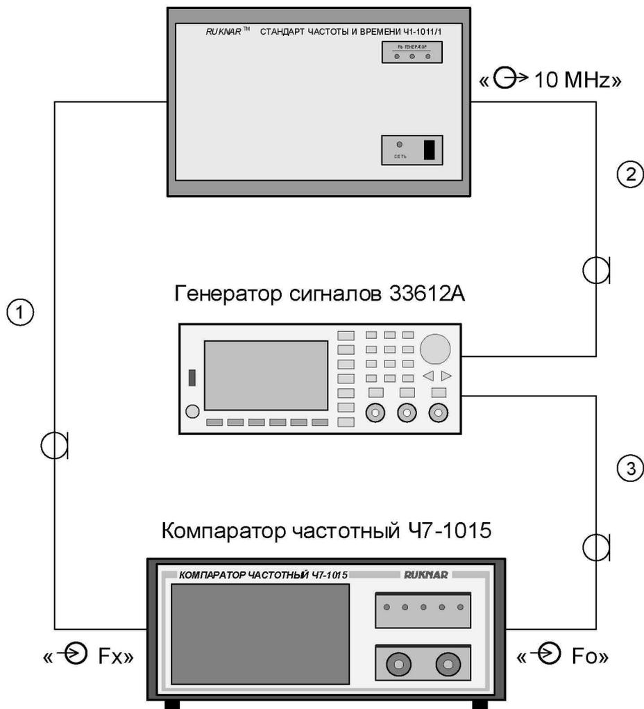
Рисунок 7.2 – Схема электрическая подключения приборов для определения отклонения частоты опорного сигнала от номинального значения.
