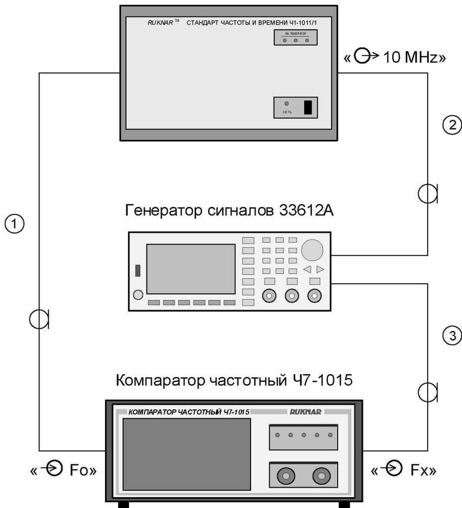
Рисунок 7.1 – Схема электрическая подключения приборов для определения отклонения частоты измеряемого сигнала от номинального значения и систематической составляющей погрешности измерений.
