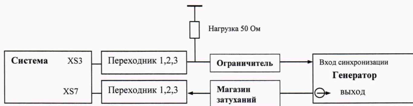
Рисунок 6 – Схема для определения абсолютной погрешности измерений отношений амплитуд сигналов на входе приемника для каналов дифракционного метода
