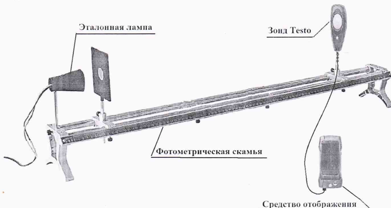
Рисунок 8 – Схема установки зонда Testo на фотометрической скамье
