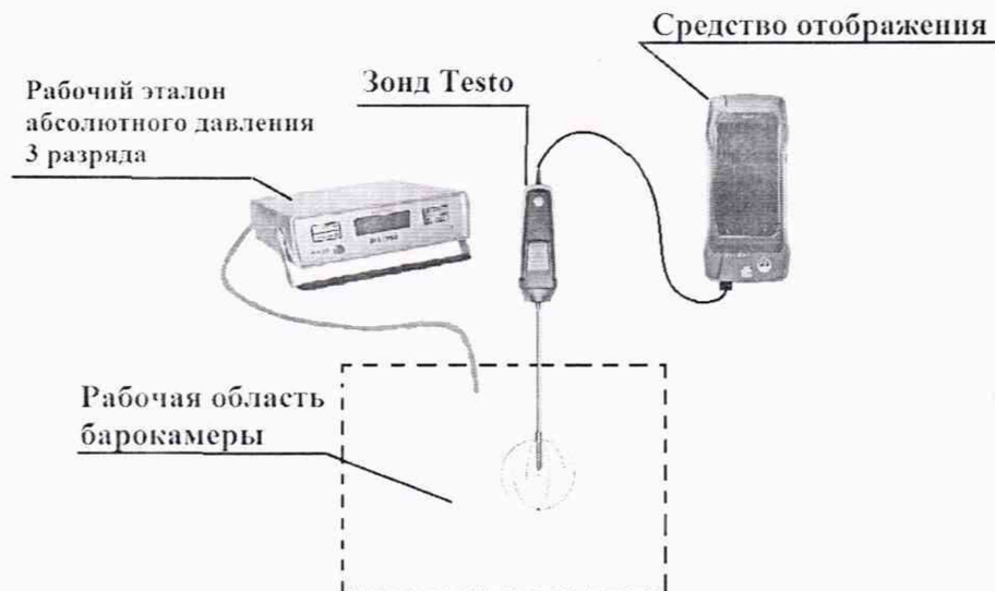
Рисунок 6 – Схема определения абсолютной погрешности измерений абсолютного давления
