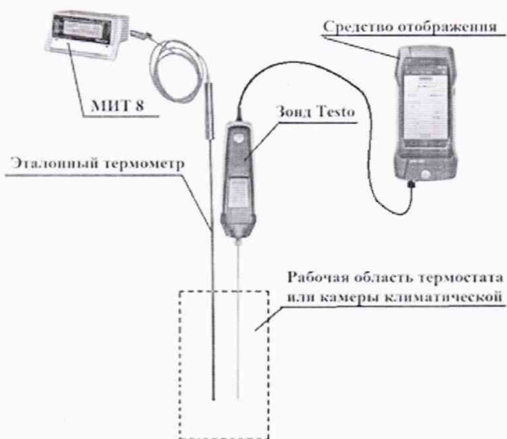
Рисунок 1 – Схема определения абсолютной погрешности измерений температуры методом непосредственного сличения
