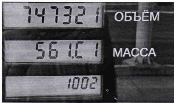
Рисунок 1 – Фотография идентификационных признаков Системы. Где «747321» – ID номер Системы, 561.61 – расширенная версия ПО, а именно «561»-версия ПО, «1002» - вариант проекта.
