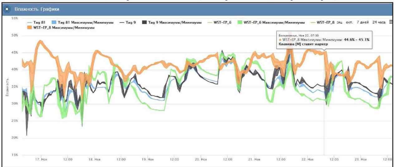
Рисунок 2.105 – Окно “Влажность. Графики” с графическим представлением часовых максимумов/минимумов результатов, зафиксированных тегами.
