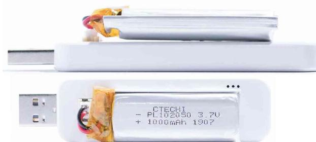
Рисунок 1.6 – Тег WST-ETM, оснащённый литиево-полимерным аккумулятором
