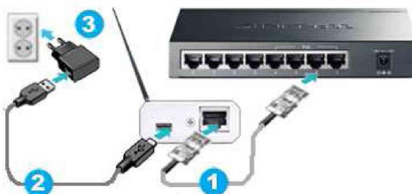
Рисунок 2.1 – Подключение менеджера WST-EMT к проводному Интернету.
