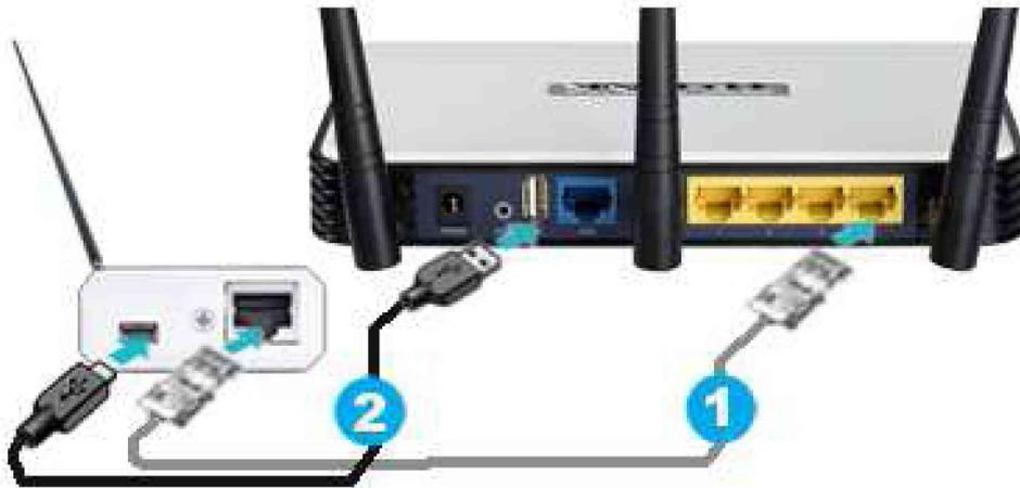
Рисунок 2.5 – Подключение менеджера WST-EMT к беспроводному Wi-Fi-Интернету
