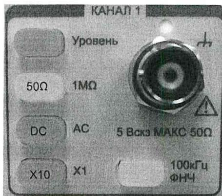
Рисунок А.4 – Параметры входного измерительного канала частотомера электронно-счетного серии ЧЗ-85/6 (п. 8.4.4)
