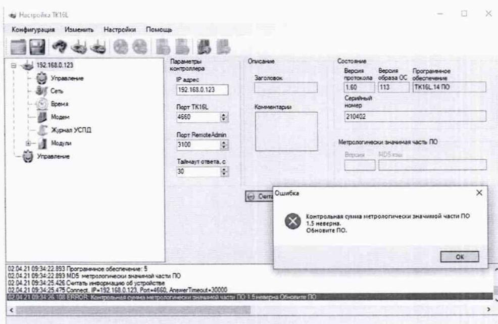
Рисунок 3. Контрольная сумма метрологически значимой части ПО неверна.
