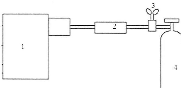
Рисунок Б.2 – Рекомендуемая схема подачи ГС на вход газоанализаторов при использовании генератора-разбавителя газовых смесей.
