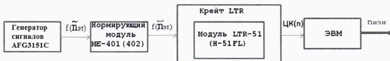
Рисунок 8.7 – Функциональная схема поверки МИЧВР
