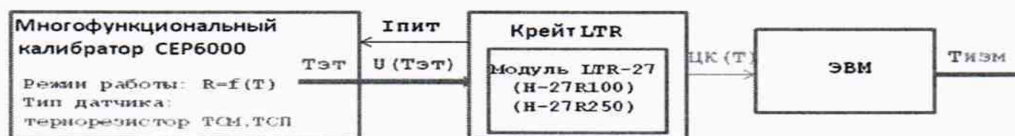
Рисунок 8.3 – Функциональная схема поверки МИТ с терморезистором
