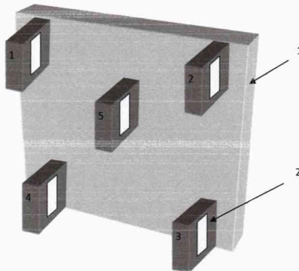
Рисунок 4 – Места установки рамного уровня (2) при определении отклонения от вертикального положения установочной пластины станда (1)
