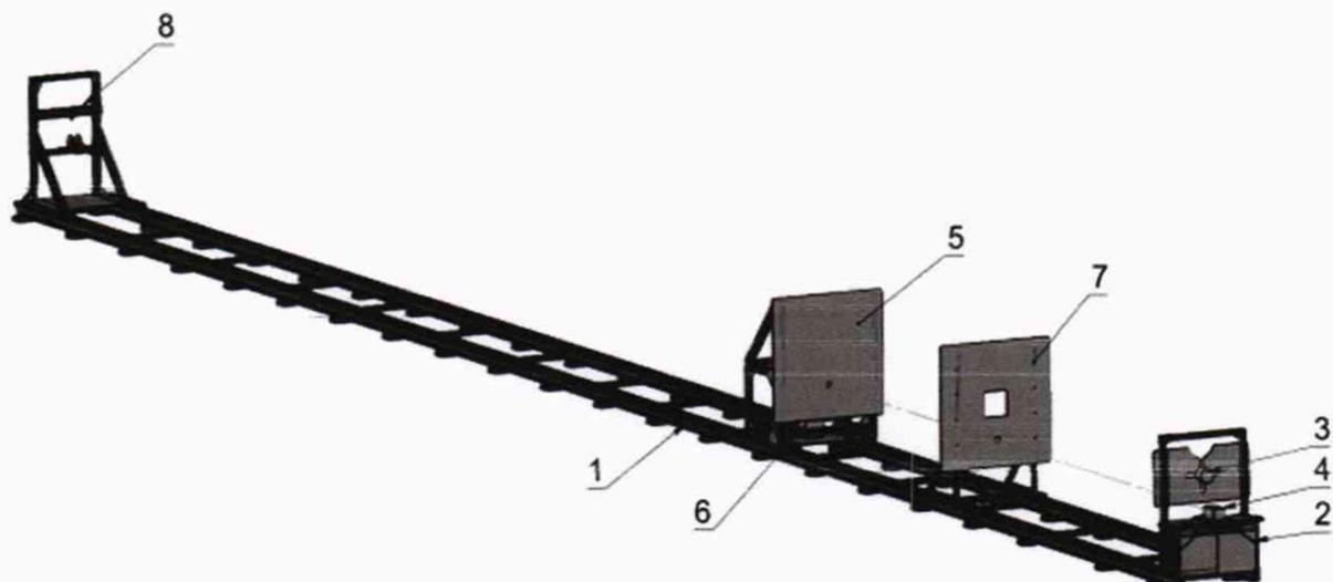
1 – горизонтальное основание; 2 – неподвижная часть; 3 – установочная пластина с поверяемым прибором; 4 – система лазерная измерительная; 5 – стойка имитатор уровня с отражающей пластиной; 6 – сервопривод для перемещения стойки имитатора уровня; 7 – стойка с поглощающим материалом для подавления помех; 8 – стойка с системой натяжения
