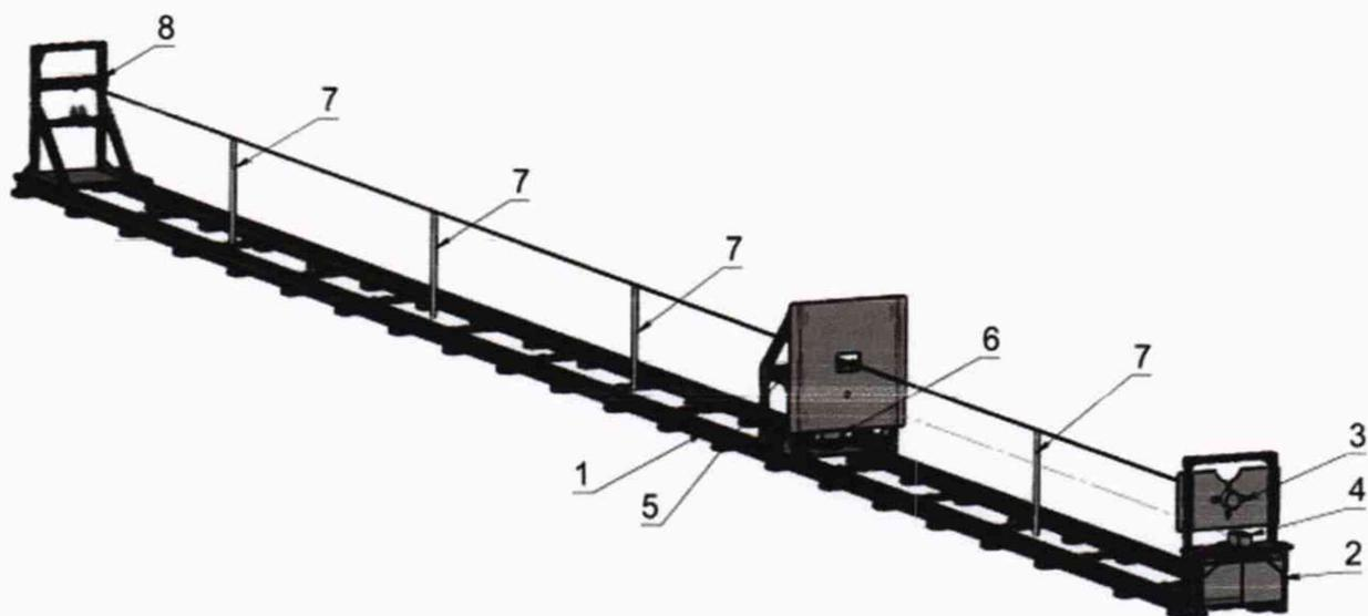
1 – горизонтальное основание; 2 – неподвижная часть; 3 – установочная пластина с поверяемым прибором; 4 – система лазерная измерительная; 5 – стойка имитатор уровня с отражающей пластиной; 6 – сервопривод для перемещения стойки имитатора уровня; 7 – стойка поддержки; 8 – стойка с системой натяжения
