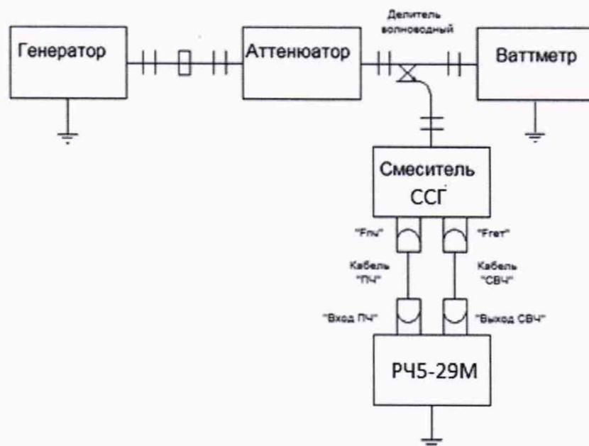
Рисунок 1 – Схема определения диапазона частот измеряемого входного сигнала
