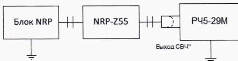
Рисунок 3 – Схема измерения выходной мощности встроенного гетеродина
